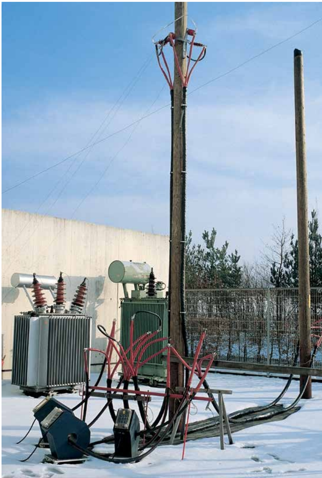
Довгострокові багаторічні випробування муфт GUST і GUSJ на кабелях із паперовою ізоляцією в лабораторіях дослідницького центру Tycso Electronics Raychem GmbH, Оттобрунн, Німеччина.
