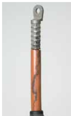
Зразок, пошкоджений трекінговою доріжкою
