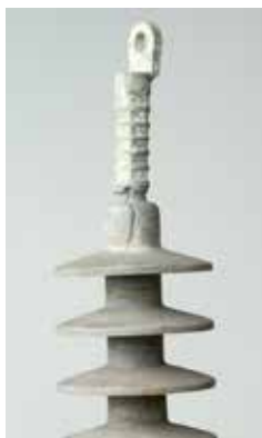
Зразок, пошкоджений ерозією
